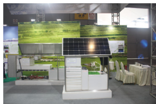
研发的12V微动力和无动力农村生活污水处理设备
